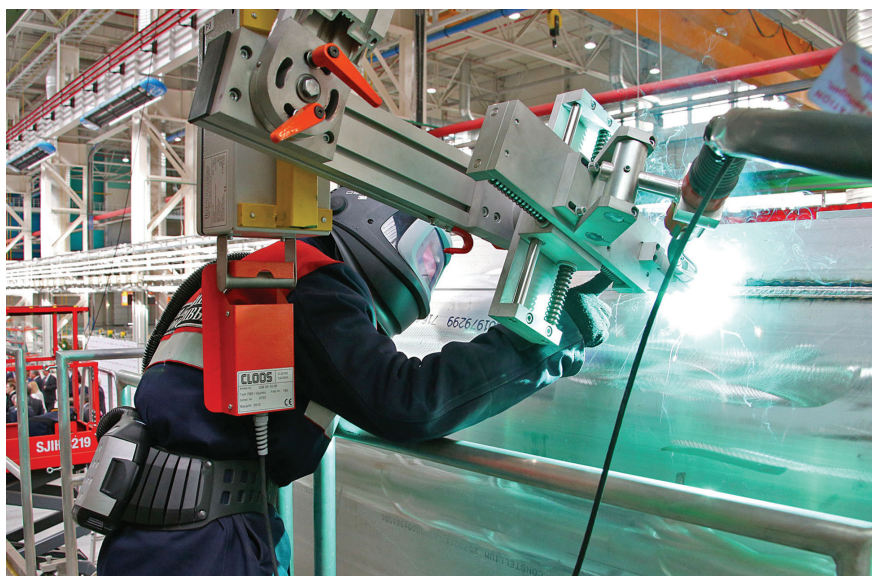
Специальный процесс сварки алюминиевых кузовов электропоездов «Ласточка» на ООО «Уральские локомотивы»
